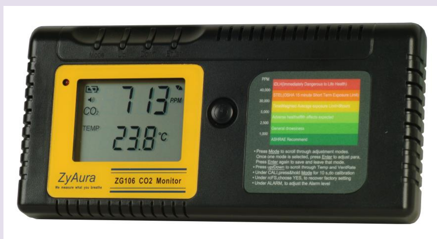
Bild 9a: Kohlendioxid Messgerät (Firmen Foto der Fa. ZyAura)
